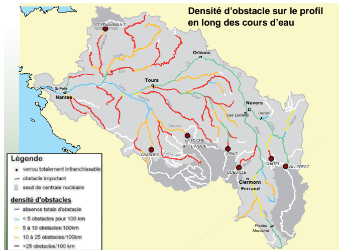
Figure 1 : Le bassin de la Loire. Les zones en gris sombre sont devenues totalement inaccessibles, les autres présentent des difficultés plus ou moins grandes, selon la densité d'obstacles pour 100 km (voir code couleur dans la légende). Si de nombreuses - mais encore insuffisantes - passes à poissons ont été installées sur les principaux barrages, leur entretien laisse souvent à désirer. Une étude LOGRAMI de 2008[1] montrait que sur 250 passes à poissons, plus de 60% d'entre elles étaient obstruées. © ONEMA
